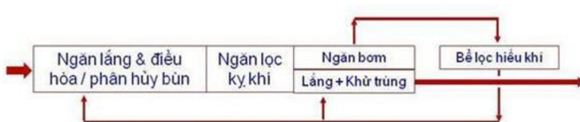
Hình 3.2: Sơ đồ nguyên lý hoạt động của bể Bastafat
